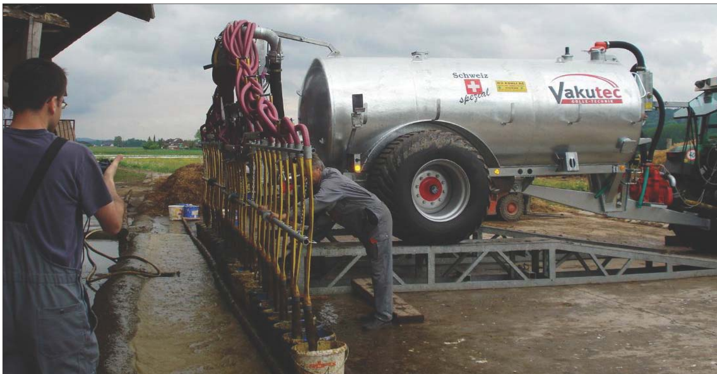
Kohli's Schleppschauchverteiler Powerpack mit Vario-Verteilerkopf auf Vakutec-Vakuumfass
