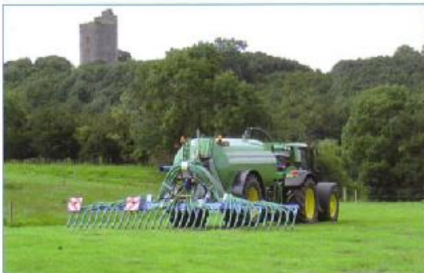
Gleitfuß-Ausbringsystem mit zentralem ExaCut für die Grünland-Düngung mit minimaler Futtermverschmutzung.
