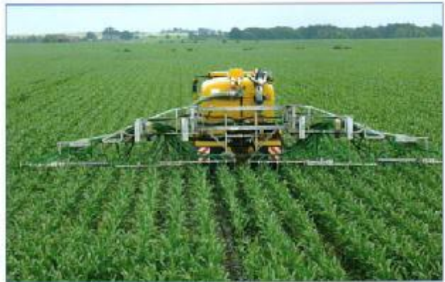
Compax - Spezial Schleppllauchgestänge für Selbstfahrer und Gülleverschlau- chung mit einer Transportbreite von nur 3 m bei 15 m Arbeitsbreite.
