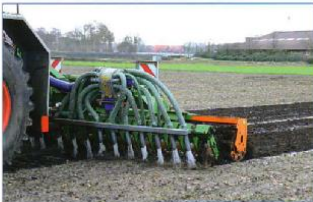
Scheibenegge für die Stoppelbearbeitung mit integriertem ExaCut Verteilerbausatz und Schlauchabgängen in DN60 für große Ausbringmengen.
