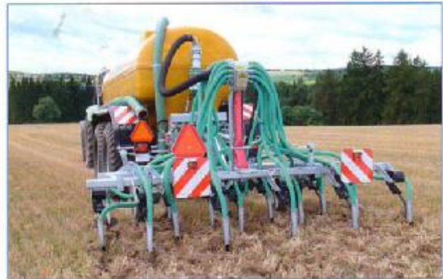
Grubber mit zentralem ExaCut für die direkte Einarbeitung der Gülle.
