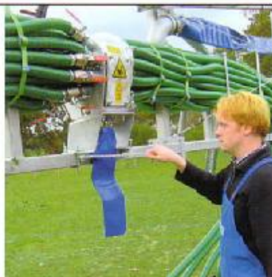
Durch die großzügigen Öffnungen ist der ExaCut sehr gut für Service- und Wartungsarbeiten zugänglich. Fremdkörper werden durch den Entsorgungsschlauch abgelassen.
