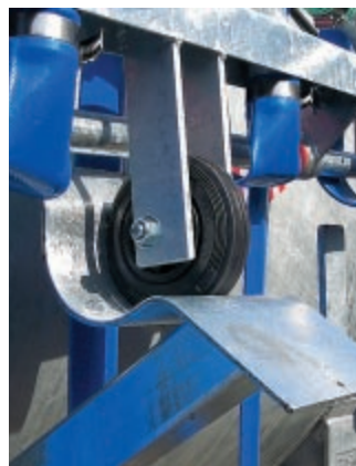
Der Balken muss in Transportstellung mechanisch gesichert sein.
