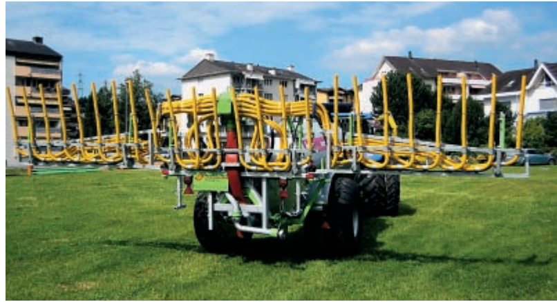
Bei diesem Verteiler von Hochdorfer können die federgeführten und stabilen Schläuche auch in Arbeitsstellung nach oben geklappt werden.
