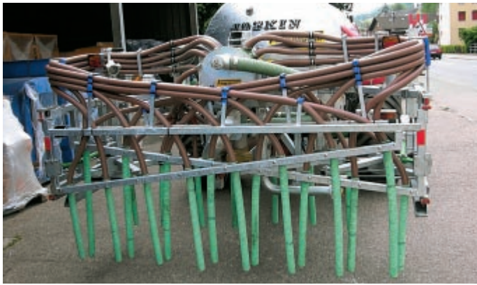
Fankhauser bläst die Schleppschläuche noch mit Luft aus und hat zurzeit noch keinen Tropfstopp im Angebot. Dieser soll aber folgen.
