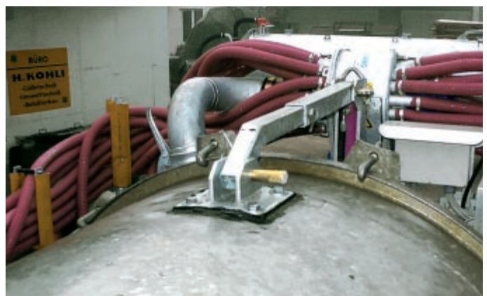
Bei älteren Fässern ohne Laschen ist eine Befestigung mit geschraubten, abgedichteten Platten möglich. Schweißen ist nicht empfehlenswert.
