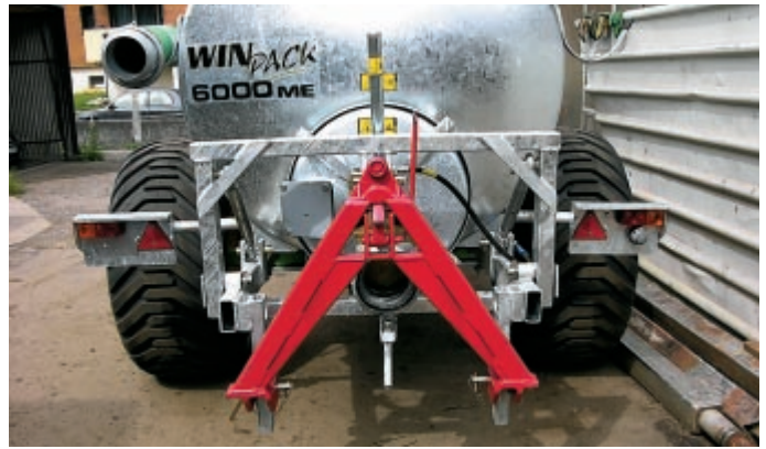
Am schnellsten baut man den Verteiler mit einem Akkorddreieck oder mit Fanghaken an und ab. Es wird mindestens eine Viertelstunde benötigt.
