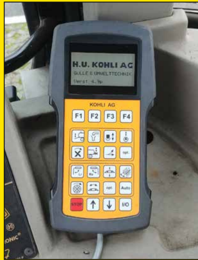
Steuerung zu Fassverteiler
