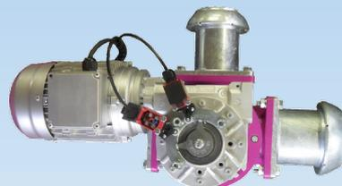
Vannes à trois voies pour la commutation eau - lisier par radio
