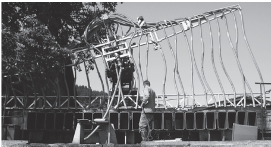
Abb. 8: 60 l-Behälter fangen die aus den einzelnen Schläuchen ausfliessende Gülle auf. Dargestellt ist die Simulation des Einsatzes bei 30 % Hangneigung mit entsprechend verlängerten Schläuchen. Die Messungen wurden bei den jeweiligen Einstellungen drei Mal wiederholt.
