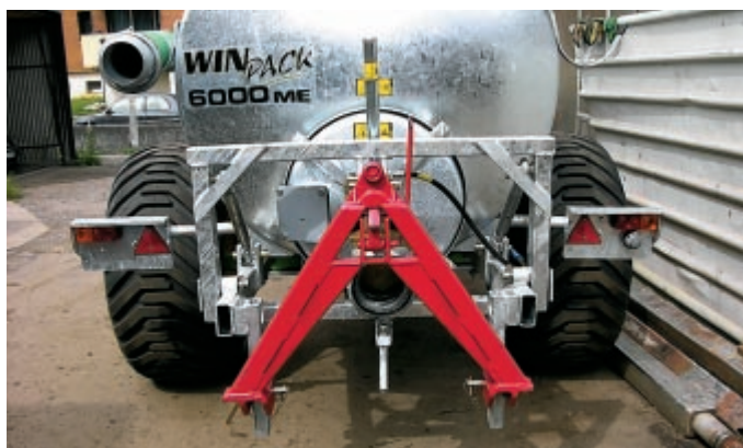
Am schnellsten baut man den Verteiler mit einem Akkorddreieck oder mit Fanghaken an und ab. Es wird mindestens eine Viertelstunde benötigt.
