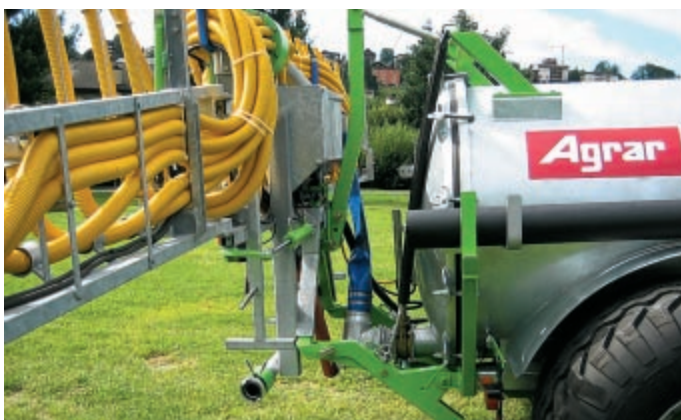
Neuere Fässer wie dieses sind bereits mit soliden Anbaupunkten vorbereitet und haben die Achse weit hinten angeordnet.
