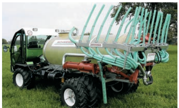
Für kleine Fässer gibt es auf dem Markt Leichtversionen wie diese von Schweizer. Sie sind aber nur bei kleinen Arbeitsbreiten stabil genug.
