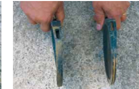
Überdrehter Schieber: ersetzen!
