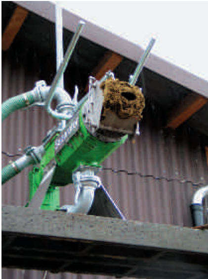
Abb. 4: Die Rohgülle wird mit einer Siebschnecke (Pressschnecke) separiert (links). Die Feststoffe werden idealerweise sofort eingestreut. Dazu ist ein ungehinderter Zugang notwendig (rechts).
