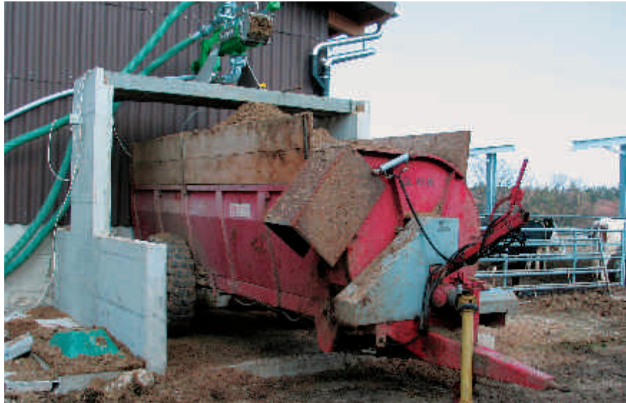
Abb. 4: Die Rohgülle wird mit einer Siebschnecke (Pressschnecke) separiert (links). Die Feststoffe werden idealerweise sofort eingestreut. Dazu ist ein ungehinderter Zugang notwendig (rechts).
