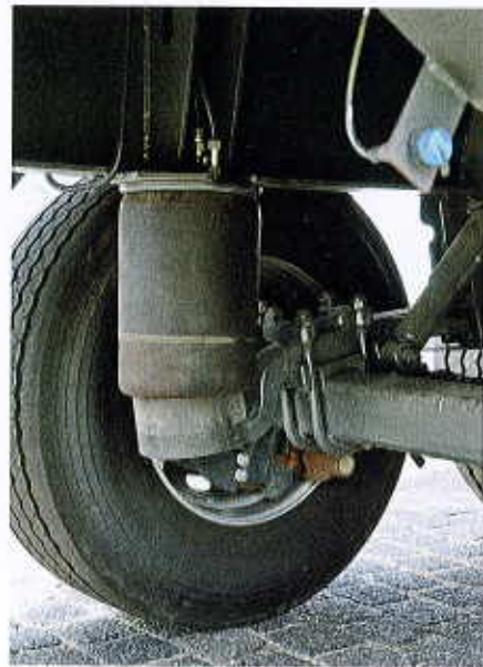
Luftfederung kommt auch für grosse Transportanhänger in der Landwirtschaft infrage.
