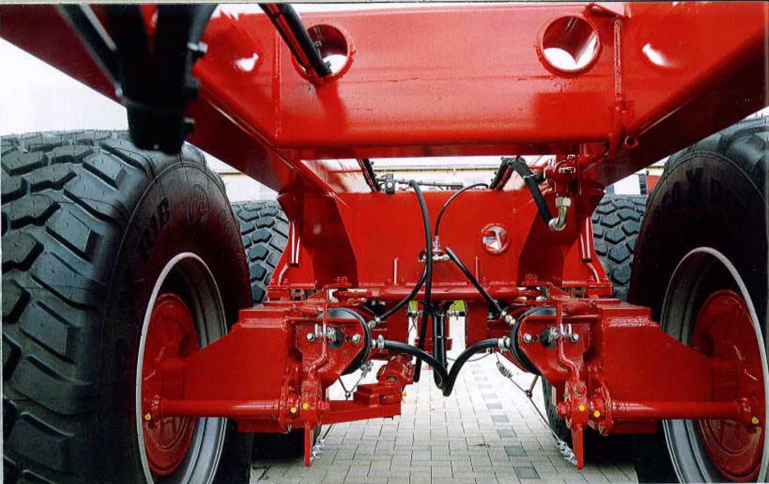
Pendelfahrwerk mit Lenkachse und pneumatischer Bremse.
