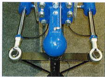
Von normierten Kupplungspunkten kann nur gesprochen werden, wenn Distanz und Höhe der 50er- mit der 80er-Kupplungskugel übereinstimmen, was hier nicht der Fall ist.
