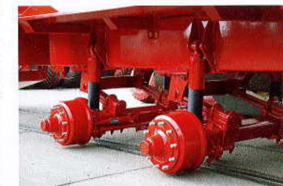
Fahrwerke mit hydropneumatischer Federung.
