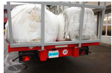
Höchstgeschwindigkeit von 40 km/h: Kontrollschild, gültiger Fahrzeugausweis, Betriebsbremse und Abreissicherung sind Vorschrift.
