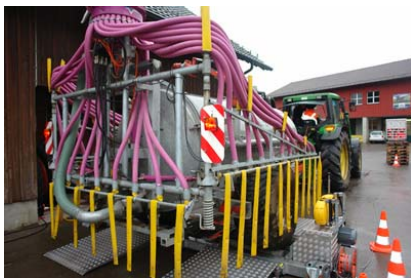
Mit einem mobilen Rollenbremsprüfstand demonstriert die Polizei, welche Transportanhänger für den Einsatz mit 40 km/h taugen.
