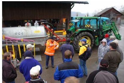
Mit einem mobilen Rollenbremsprüfstand demonstriert die Polizei, welche Transportanhänger für den Einsatz mit 40 km/h taugen.
