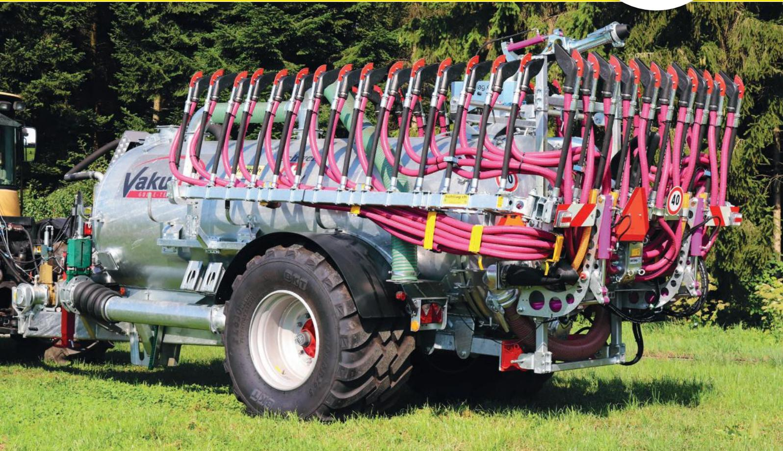
Le Starrmax est la rampe d'épandage à patins de catégorie professionnelle. Grâce à sa construction bien pensée, cette machine associe grande robustesse et poids léger. Le pendule latéral intégré, les patins à grande ouverture fabriqués par nos soins et la commande sophistiquée ne sont que quelques exemples de tout le potentiel de cette machine. Technique professionnelle – pour les exigences de qualité les plus élevées.
